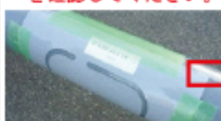
写真-3 ケガキゲージ ガムテープ固定
